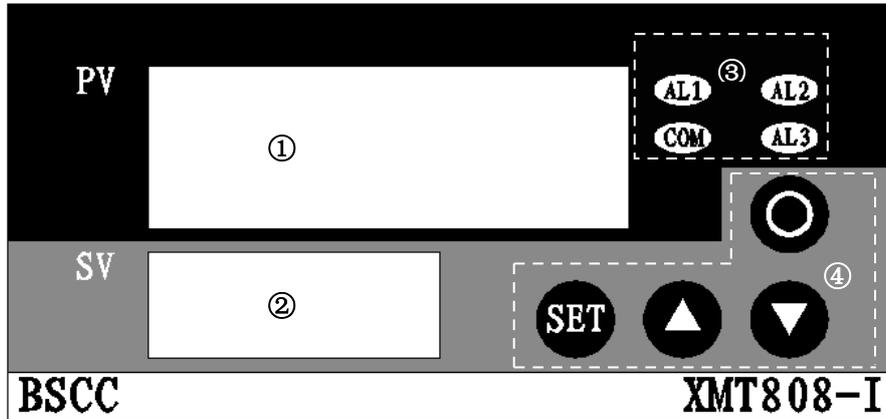
①---测量值显示窗口；②---设定值显示区域；③---报警指示区域；④---按键区。
