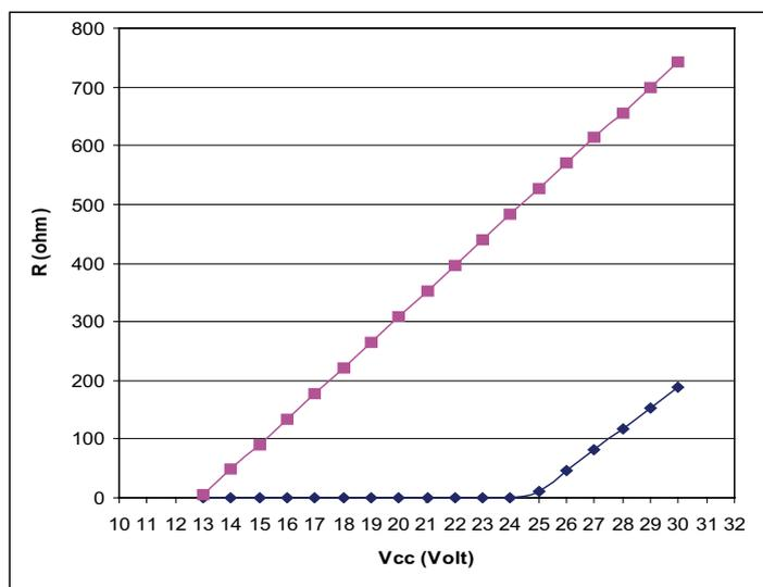
此图显示了4-20mA 变送器的负载与供电电压之间的最佳比率。
