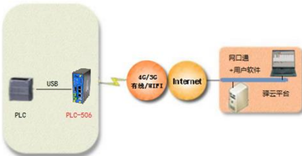
图 1-10: PLC-506 的 USB 共享功能实现 PLC 的 USB 口远程监控和程序更新
