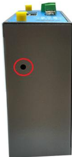
图 1-8: PLC-506 恢复出厂设置按钮
