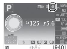
选择开启可使用曝光指示确定照相机在手动对焦模式（□62）下是否正确对焦（请注意，在拍摄模式M下，曝光指示用来表示拍摄对象是否正确曝光，该功能不适用于此模式）。
