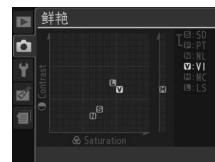
使用自动对比度和饱和度的优化校准图标在优化校准网格中显示为绿色，且线条平行于网格轴。
