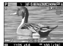
照相机对焦期间, 对焦点以绿色闪烁。若照相机可进行对焦, 对焦点将显示为绿色; 若照相机无法对焦, 对焦点则以红色闪烁。请注意, 对焦点以红色闪烁时, 照相机仍可拍摄照片。拍摄前请在显示屏中检查对焦。除在 $\text{AUTO}$  和 $\text{④}$  模式下以外, 按下 $\text{AE-L/AF-L}$  按钮可锁定曝光( $\text{□}80$ )。半按快门释放按钮可锁定对焦。
