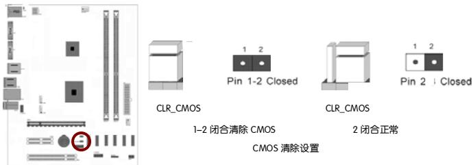
**提示:** 清除 CMOS 对于主板用户来说是一个很基本但也是一个很重要的技巧, 根据主板工程师的经验: 1. 它可以清除开机密码 2. 在超频失败后计算机无法启动时 3. 您的主板不能点亮的时候, 或是您的计算机不能进入系统, 出现错误代码提示; 或者是您的计算机出现“奇怪”的软硬件故障时, 你都可以尝试清除 CMOS, 有时是可以解决问题的, 这只是主板工程师的一些经验. 但是清除 CMOS 后计算机上的显示时间会变为出厂时的设置, 所以用户要重新设置时间, 清除 CMOS 后最好在 BIOS 里优化一下 BIOS (Load Optimized BIOS) 4. 跳线丝印处有白色标记的地方为第一脚
