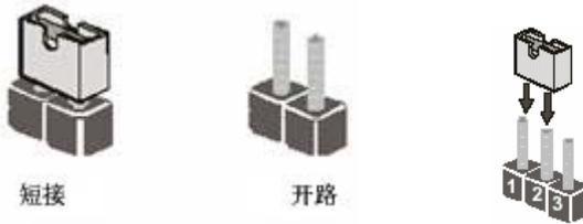
以上是 3 个针脚跳线的举例，第一个针脚和第二个针脚是短路状态。
