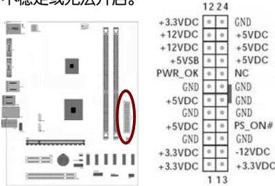
**提示:** 电源的电源线插口与主板上的电源接口均具有防呆设计，当你很容易地接入时，证明你的接法是正确的，否则是很不容易接入的，插错接口会烧主板，电源，因此请务必小心!请参看下图。
