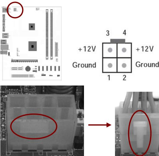
**注意：** 1.请务必连接 4 引脚或 8 引脚+12V 电源插头，否则可能无法顺利启动电脑。2.如果您的系统会搭载相当多的外围设备，请使用较高功率的电源以提供足够的设备用电需求。不适用或功率不足的电源，有可能会导导致系统不稳定或难以开机。3.如果您想要安装功率消耗较大的硬件设备，请务必使用较高功率的电源以提供足够的设备用电需求。
