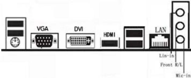
背板输出及输入接口包括：PS/2 端口， USB 接口，千兆 LAN 接口，显示器接口(VGA/DVI)，HDMI 接口， Line-in 插口，Front R/L 插口，Mic-in 插口
