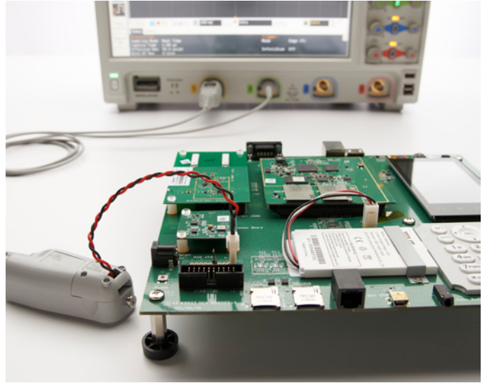
图 1. 是德科技超灵敏的 N2820A/N2821A 电流探头 (分辨率最低可达 50 \mu A) 具有卓越的测量能力,适用于测量通常在使用电池供电的设备中出现的小电流。
