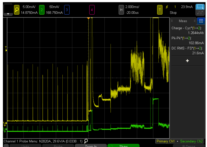
图 6. InfiniVision 3000 X 或 4000 X 系列示波器也可以与 N2820A/21A 电流探头配合使用，提供相同的低增益和/或高增益同时视图，以支持更宽动态范围的电流测量
