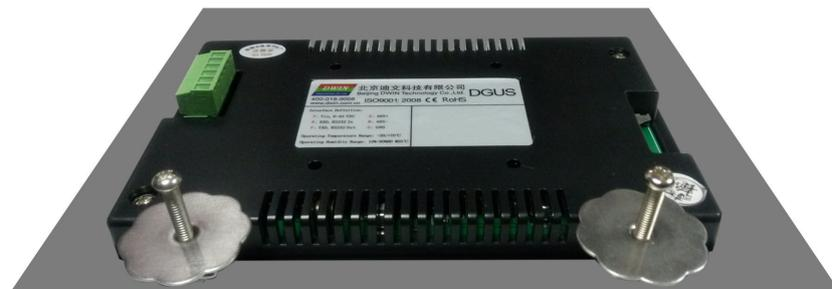
第三步：旋紧螺丝，将HMI固定在设备上。
