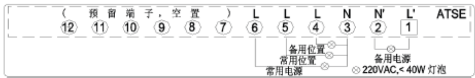
图5: 5TR1型ATSE 外接端子示意
