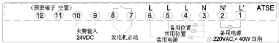
图6: 5TR2型ATSE 外接端子示意
