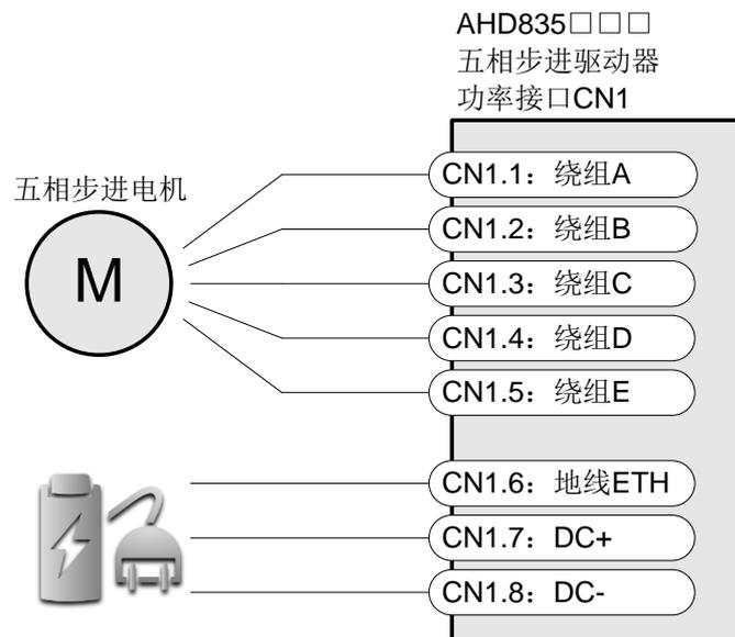
**危险** 如果电机地线不接到驱动器外壳接地孔，务必保证电机已经可靠接地，同时本驱动器也已经可靠接地。
