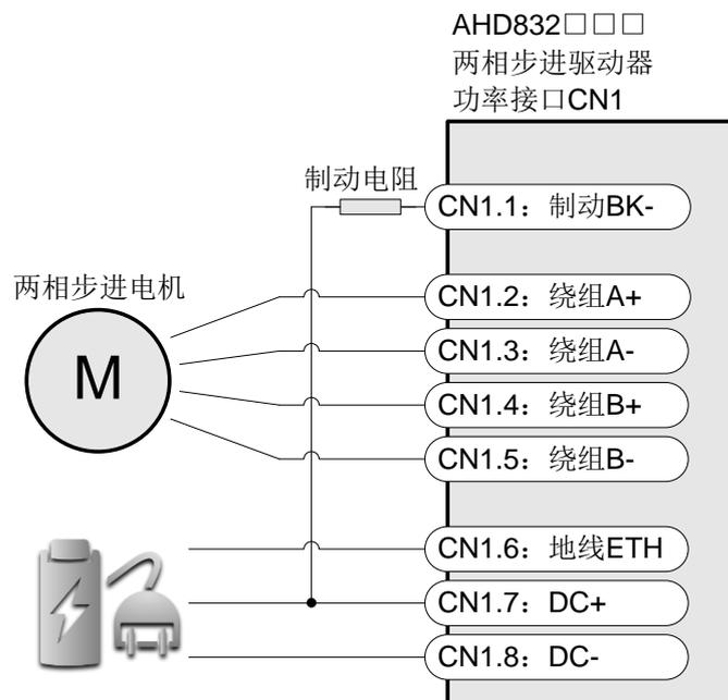
**⚠危险** 如果电机地线不接到驱动器外壳接地孔，务必保证电机已经可靠接地，同时本驱动器也已经可靠接地。
