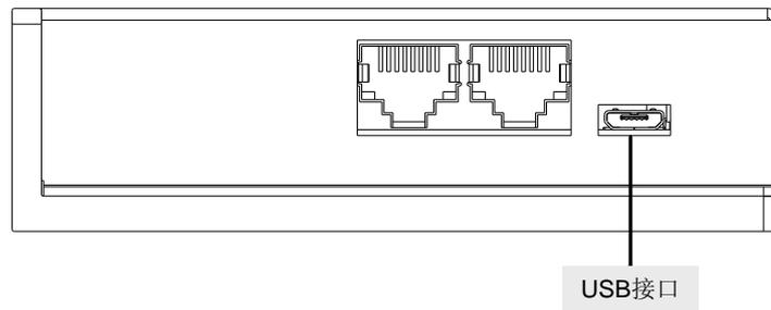
驱动器内置 USB 芯片，任何可以作为 USB 主机的设备，比如电脑、安卓手机等，都可以按照 Modbus-RTU 协议，对驱动器进行参数设置，或者直接控制驱动器的运行。
