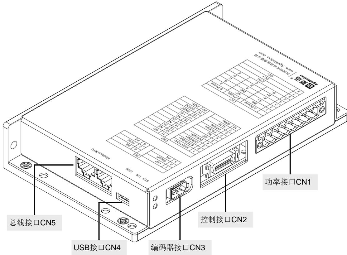
**提示** 接线时，必须等驱动器完全断电后，拔下插头，完成接线，然后再插回驱动器插座。
