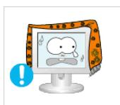
▶ 请勿盖住显示器机壳上的通风孔。
