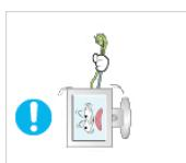
▶ 请勿尝试仅通过拉动线缆或信号线来移动显示器。
