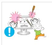
▶ 不要将任何金属物体插入显示器的缝隙。
