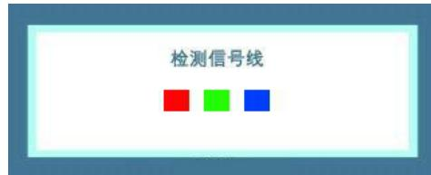
如果工作正常时拔下视频电缆或电缆受损，将显示此框。
