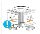
▶ 请勿尝试仅通过拉动缆线或信号线来左右移动显示器。
