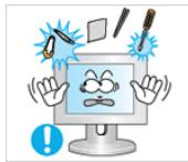
▶ 切勿将金属物体（如筷子、缆线和工具）或易燃物品（如纸张或火柴）塞入通风孔、耳机端口或AV端口或其他端口。
