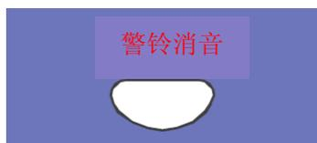
打开或关闭控制屏中继电器的活动状态（切换功能），在用户数据中，已经为某些继电器功能设置“关闭声音报警”功能，例如连接声光报警信号发送设备的继电器。继电器的隔离状态将在“隔离”指示灯上显示。
