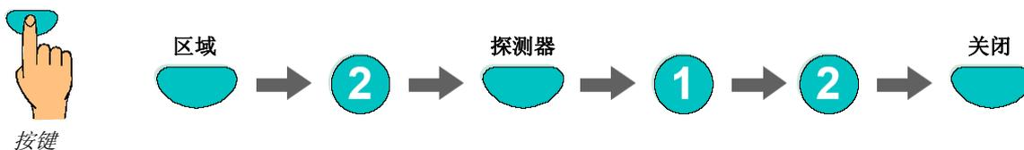
图 25: 隔离探测区 2 中的探测器 12 (示例)
