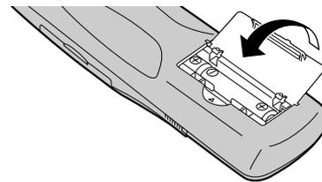
リモコン表示部が薄暗くなってきたら、電池を交換してください。(使用環境、使用回数などにもよりますが、電池の寿命は約1年です)
