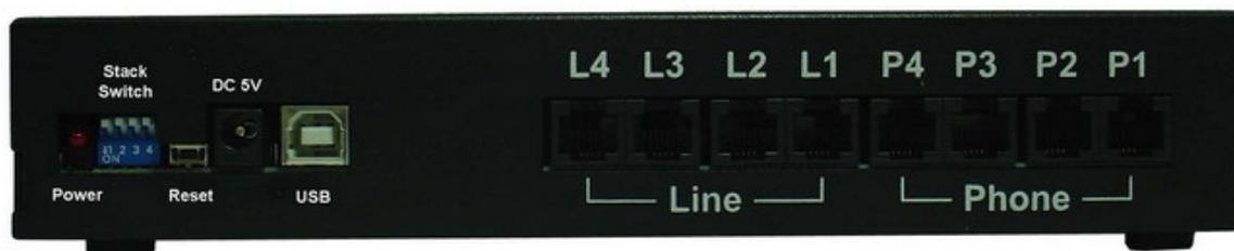
1. 将 5 伏/3 安培直流电源变压器连接至 5V DC 插座。电源指示灯恒亮。
