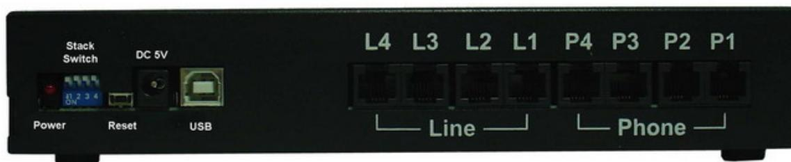
1. 将 4 条电话线的一端分别连接至 Phone 1 ~ Phone 4，相对应的另一端分别连接至 PBX 的外线卡电话接口，例如 Phone 1 连接对应到 PBX 外线卡电话接口 1。
