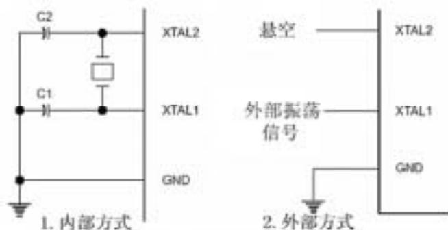
图 2-2 外接晶体引脚
