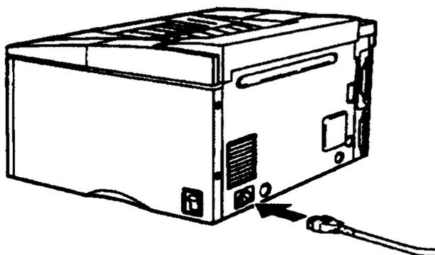
3. 将电源电缆另一头的插头插入带有保护地线的电源插座。
