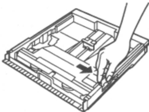
6. 将打印纸要打印的那一面向上，然后将其放入纸盒，向前移动纸张，使其前端的两角位于纸盒前面的金属夹下。
