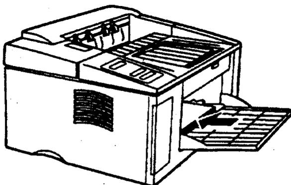
6. 调整侧面的导向定位板使其靠着纸张。
