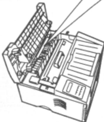
3. 确定卡纸的位置，仔细地按作图箭头所示的方向拽出卡住的纸，并将遗留的碎纸片取出来。
