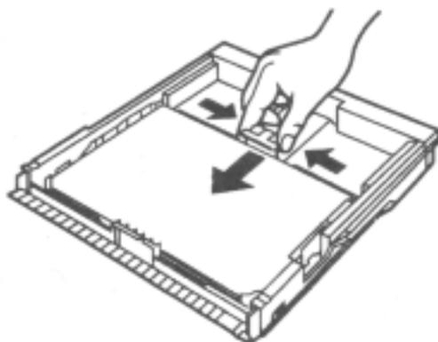
**注释：** 要确认纸张的后边是位于末端定位板的突出小边的下面。要确认该板的定位锁是位于纸张规格刻度边上的定位槽中。
