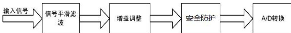
模拟量输入采样前端调理电路图
