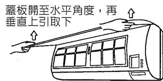
**拆** • 面框蓋板開至水平角度，再垂直上引，即可取下面框蓋板，進行面框蓋板清洗、安裝配線、過濾網清洗等保養、安裝動作；回復動作為反方向進行即可。
