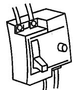
在配線接觸不良下連續運轉，將導致過熱、發生火災或起動運轉不良。
