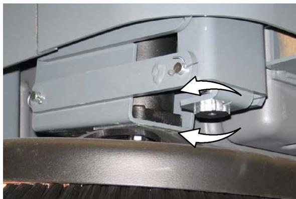
**ROTATING AND REPLACING THE SIDE BRUSH GUARD**
