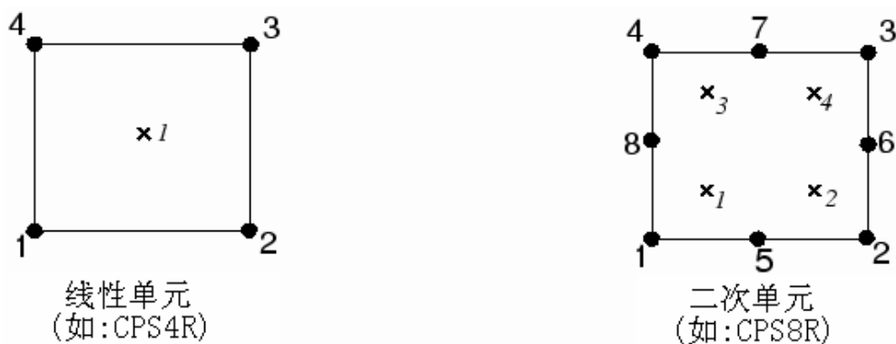
图 4-7 采用减缩积分的二维单元的积分点
