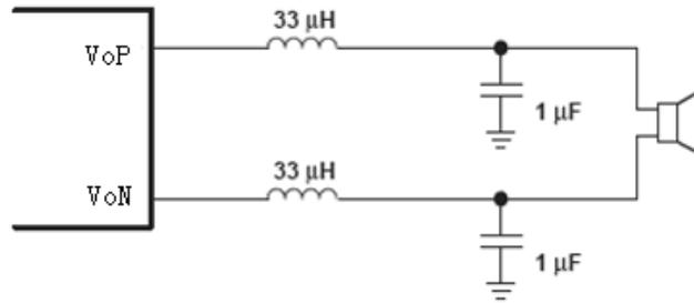
输出加 LC 滤波器典型应用电路（截止频率为 28KHz）
