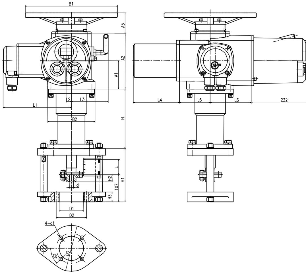
SND-ZTZ (带支架) 外形及连接尺寸图
