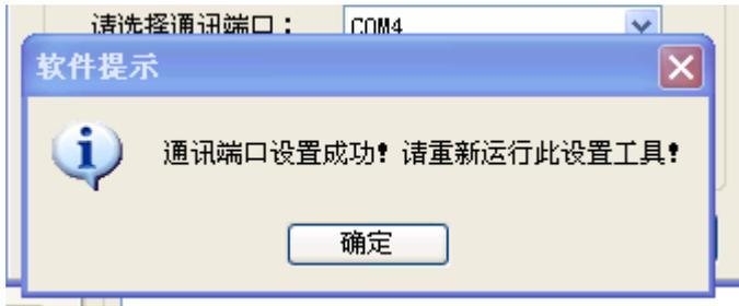
重新运行 WS1311 无线远程室温监测仪设置工具程序，默认界面为参数设置页面，点击右下角的 打开串口，串口打开后，只有先点击 关闭串口 或 退出 后，才允许拔下数据线，否则系统会出错误。
