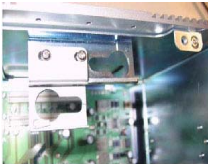
图 3.3： 安装第二块 PCI 总线卡
