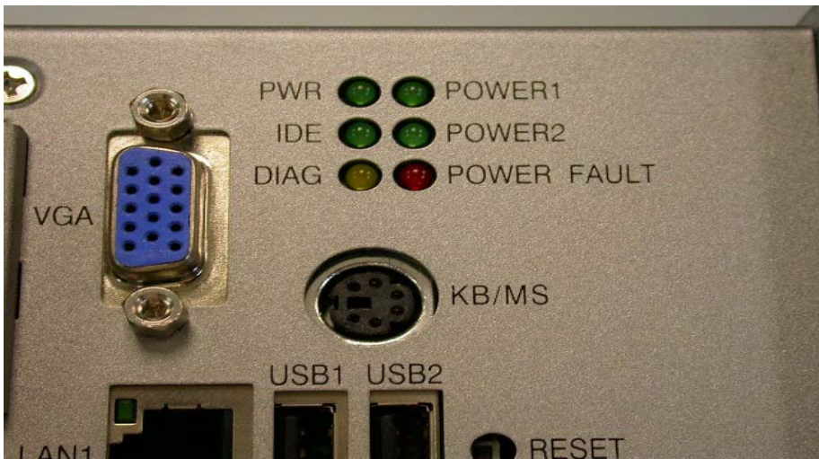
图 2.12: LED 指示灯监控电源输入
