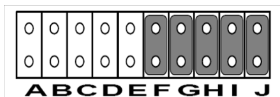
图 2.2：RS-422/485 跳线设置
