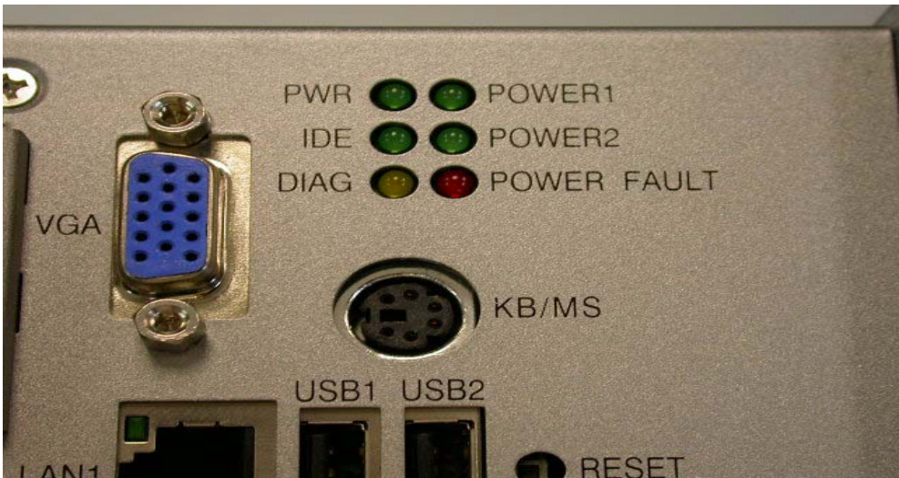
图 2.13: 用于系统故障诊断的 LED 指示灯的位置
