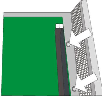
小心地倾斜硬盘保持架，插入其原始位置。确保保持架不会挤压电缆。金属弹片卡接到位。
