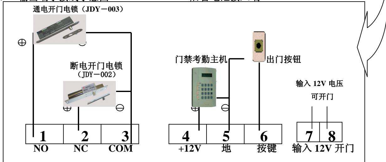
六、 1—3：NO 端与 COM 端，常态无输出，按键触发后输出 DC12V (0~10 秒)，
