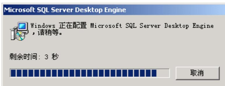
步骤十一 MSDE 安装完成后, 如果 Windows 操作系统要求您将 NetInsight 主机重新激活, 请按照 Windows 操作系统的要求来重新激活 NetInsight 主机, 并且在系统重开机后, 重复上述“步骤一”至“步骤六”之 NetInsight 安装步骤, 然后在“步骤七”回答“否”, 并且确认不再安装 MSDE, 接着安装程序将执行“步骤十二”。
