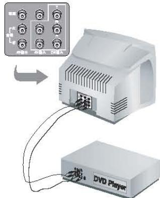
① 把电视机的绿色, 蓝色, 红色Y Pb Pr (CVI输入)插座连接到播放器上相应的普通分量视频输入端子。
