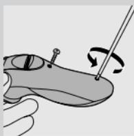
**2** 讓電鬚刀持續運轉直到完全停止，然後轉開電鬚刀背面的兩個螺絲。
