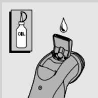
**3** ทุกๆ หกเดือน ควรหยดน มั่นจักรเพื่อหล อลื่นซี่ฟันของที่กันจอน
