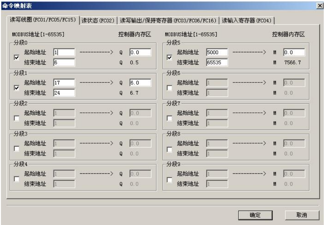
图 4-23 MODBUS TCP 服务器通信组态之命令映射关系
