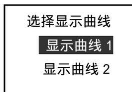
用户可短时间按压开锁按钮把选择光标移动到所要选择的选项上，然后按确认键，设置成所希望设置的显示曲线。随后，电脑钥匙执行此次选择的结果，并在 LCD 显示器显示所设置的显示曲线的效果。用户可随时按压电源开关按键返回“设置”子菜单。此项菜单在出厂时已经设置好 LCD 显示器的显示曲线，一般不需要更改。
