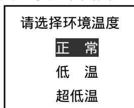
用户可短时间按压开锁按钮把选择光标移动到所要选择的选项上，然后按确认键，设置成所希望设置的环境温度即可，随后，电脑钥匙执行此次选择的环境温度工作方式。用户可随时按压电源开关按键返回“设置”子菜单。
