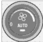
AUTO (自动) 功能可自动调控恒温控制系统, 保持所选择温度。AUTO (自动) 功能控制加热、空调、风扇速度、再循环及空气分配。
