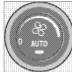
转动旋钮以提高或降低风扇速度。若选取自动 AUTO (自动) 则风扇速度自动调节。之前设定的风扇速度不再作动。
