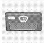
用于快速去除挡风玻璃与侧车窗雾气及结冰。气流以高风扇速度吹向车窗。除雾器按钮内的指示灯在此功能启动时点亮。
