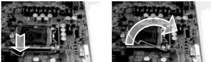
接着移除处理器插座上的黑色塑料保护盖，露出插座本体，注意此时千万不要用任何物体接触插座上的金属触片，以免导致插座损坏；
