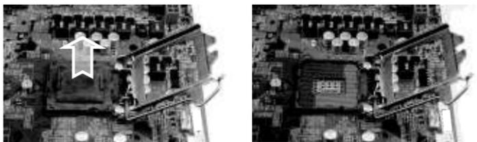
确定处理器边缘上的两个凹槽与插座上的两个凸点位置吻合，把处理器放入插座内，动作一定要轻盈柔和，避免损伤插座触片。
