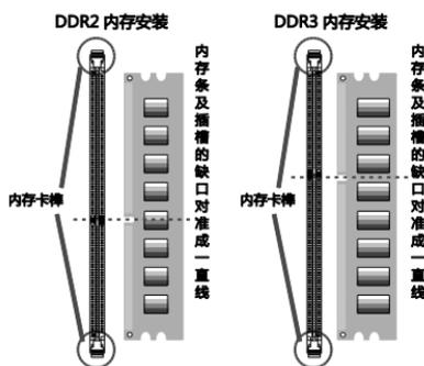
在DDR3\_A2或A4插槽上，只有在这两个插槽插满内存之后，其他颜色的插槽才能正常使用。
