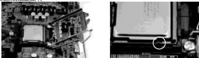
然后将金属顶盖放下，当金属顶盖的楔形尖端锁入固定螺丝下端后，转动金属杆，重新锁定金属杆。
