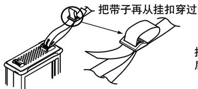
把肩带扣入 AQ7270 右侧的肩带扣内，在仪器上方两侧有两个肩带扣，按如图所示的方法，把肩带穿过肩带扣，然后扣紧。
