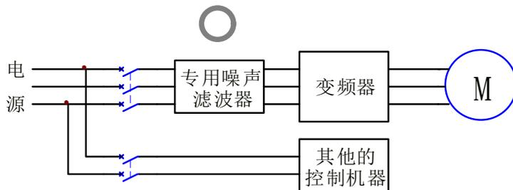
图 4-2 电源侧噪声滤波器的正确设置
