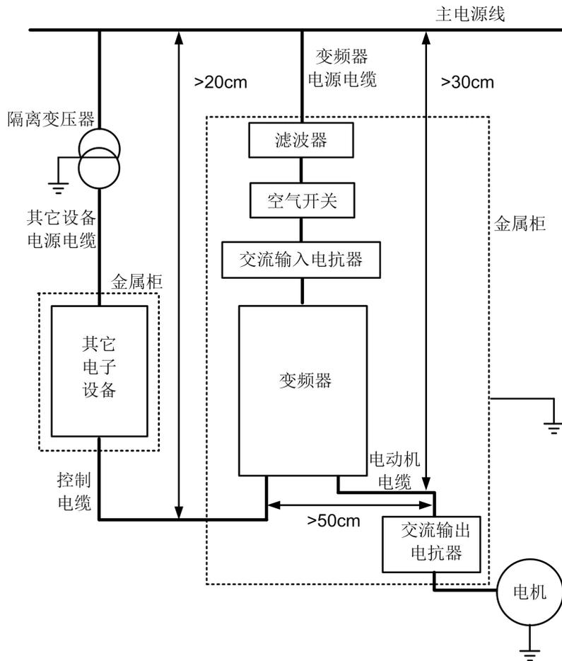
附图 A-12 变频器电气安装示意图
