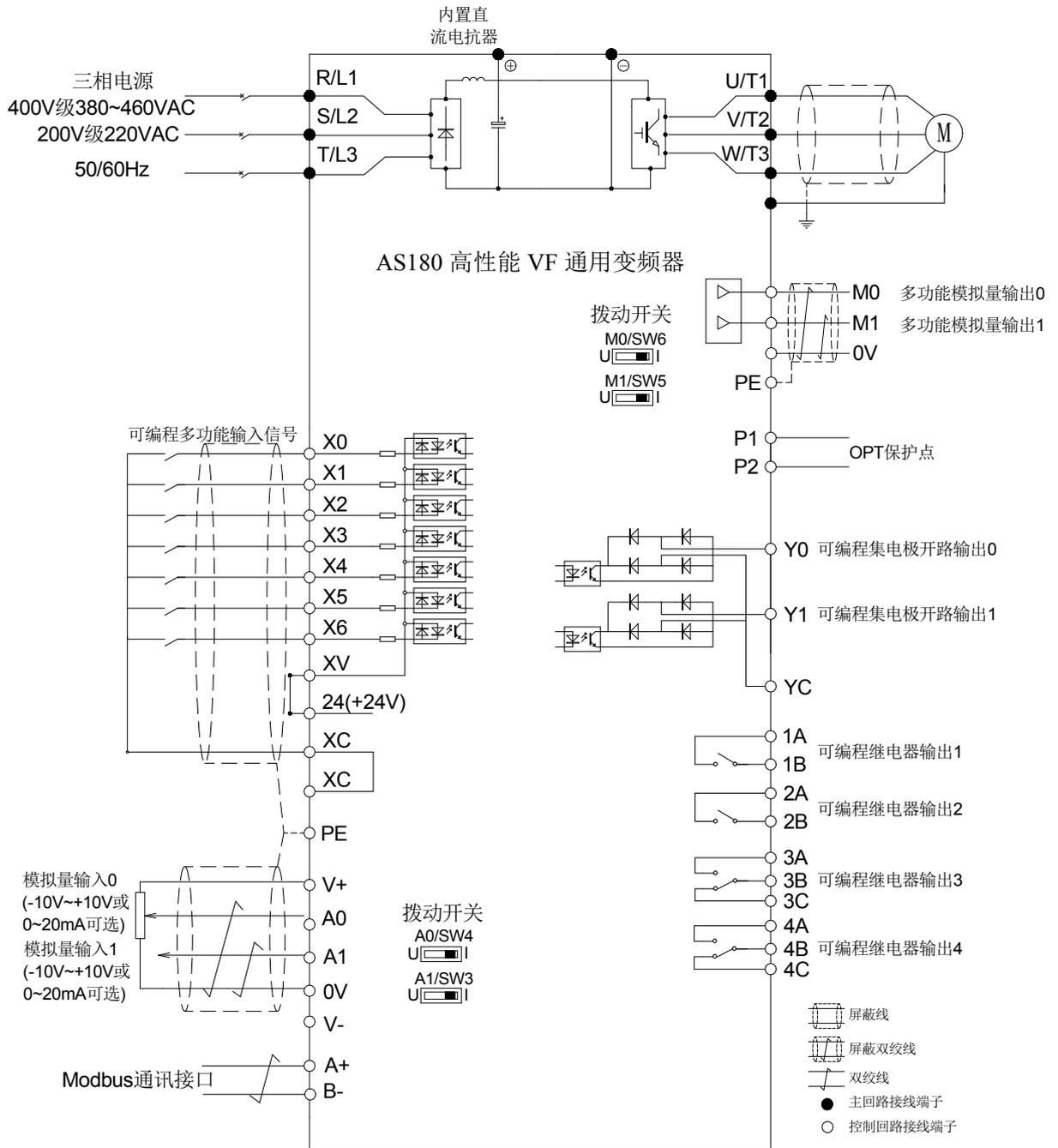
图 4-8 变频器端子配线示意图 2(30kW 以上)
