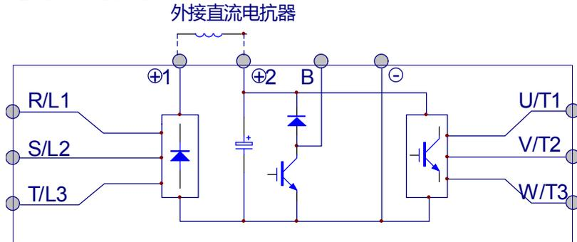
图 4-12 外接直流电抗器的连接图
