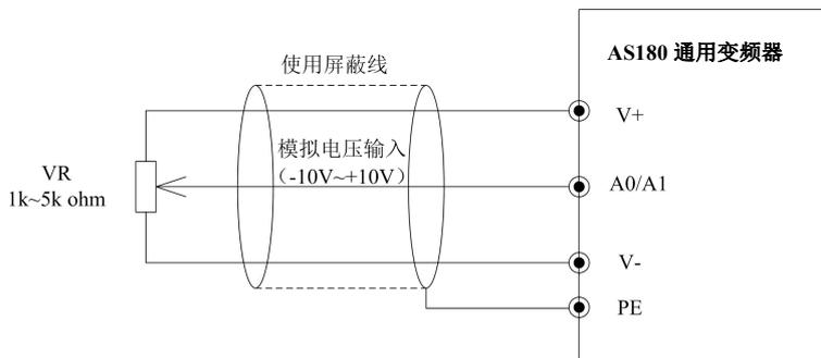
图 4-26 模拟量信号屏蔽线接线示意图
