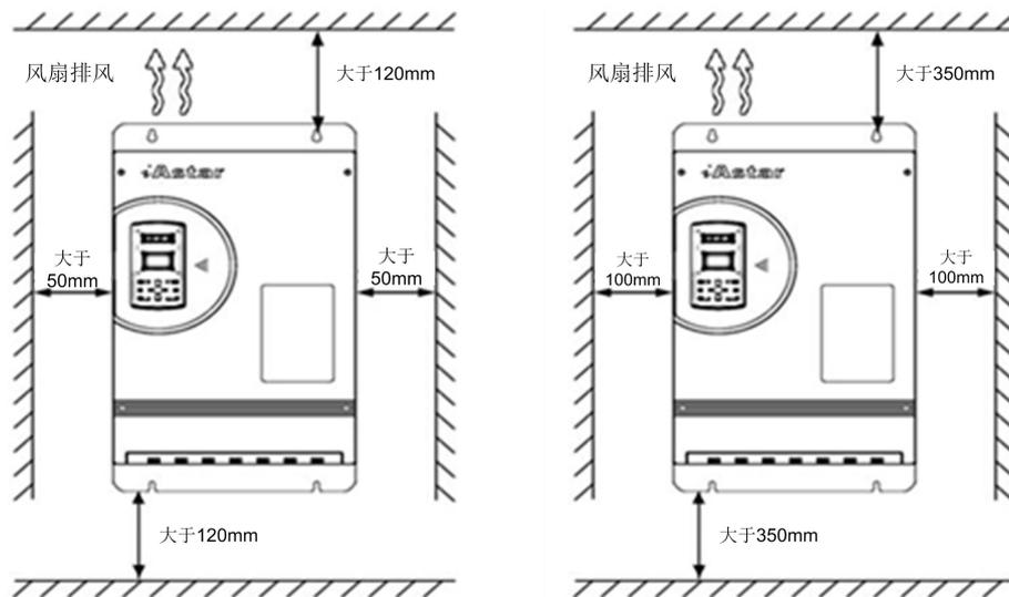
a) 45kW 及以下变频器的安裝間距示意图      b) 55kW 及以上变频器的安裝間距示意图
