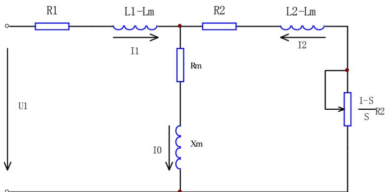
图 7-14 异步电机稳态等值电路图
