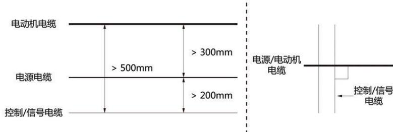
图 4-19 主电路配线的布置图 1
