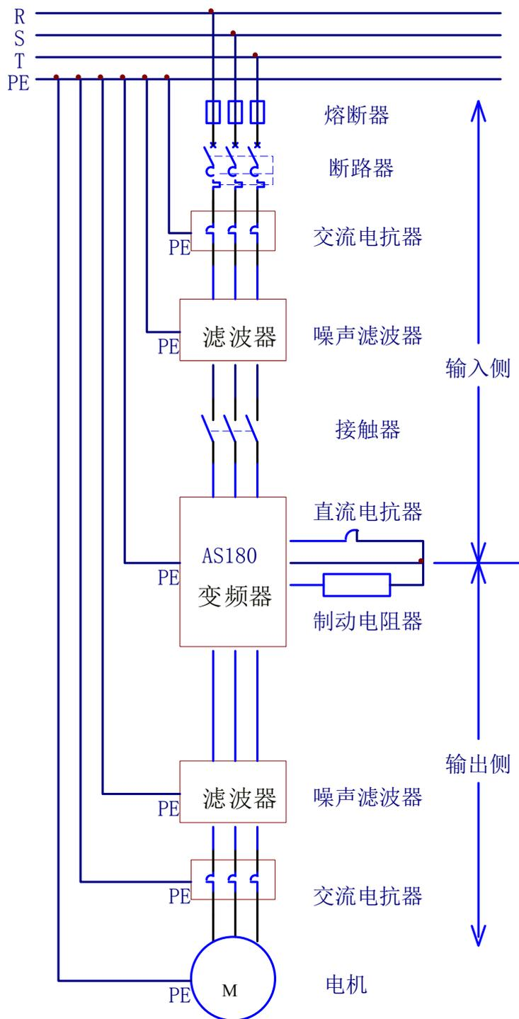
图 4-1 变频器与外围设备的连接图
