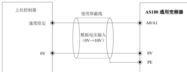
图 4-27 模拟量电压信号接线示意图
