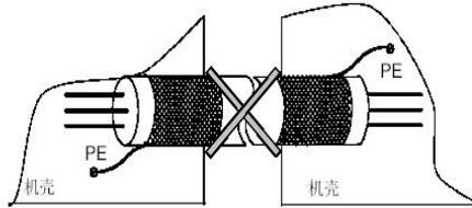
附图 A-5 不正确的屏蔽接地方法
