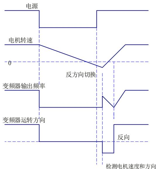
图 7-7 转速跟踪起动方式示意图
