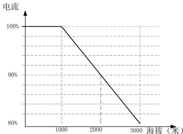
图 3-1 变频器额定输出电流与海拔高度的关系图
