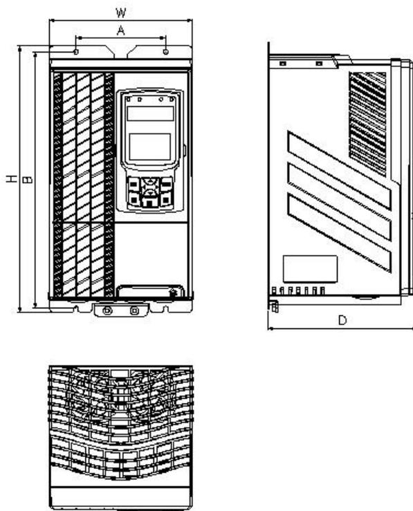
图 2-7 A1 规格变频器安装尺寸
