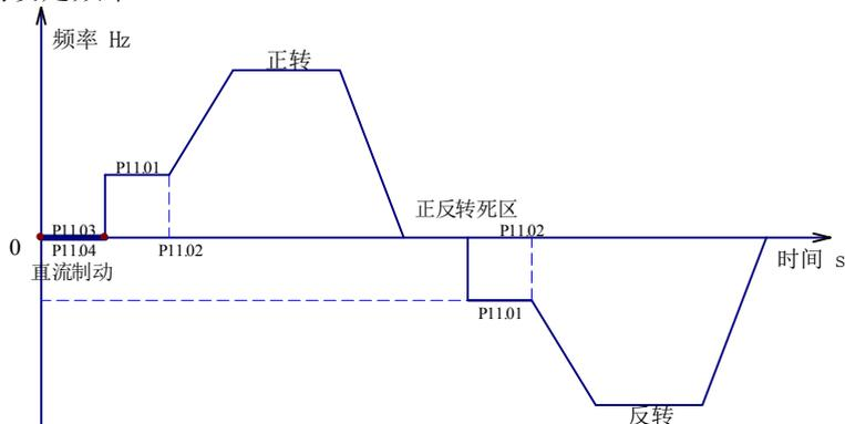
图 7-6 直流制动起动方式示意图
