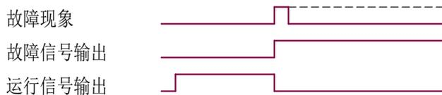
图 7-15 故障信号的时序
