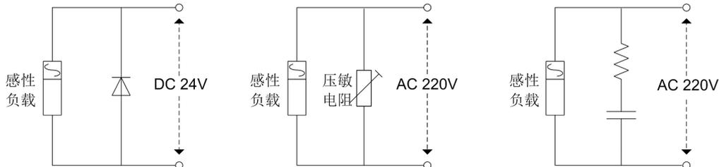
图 4-18 感性负载浪涌抑制器的应用
