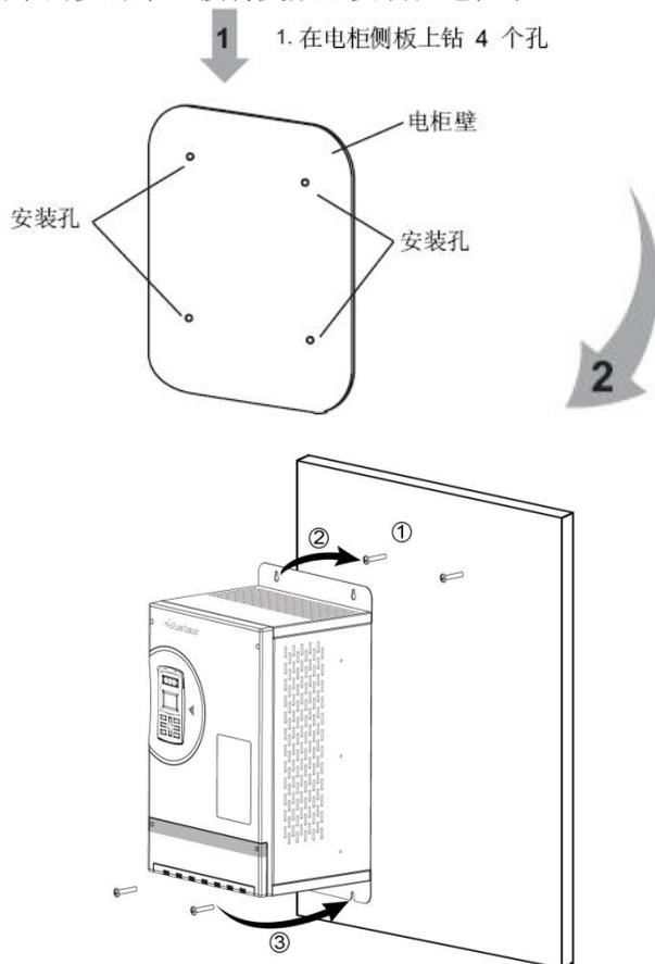
图 3-5 变频器的安装顺序图
