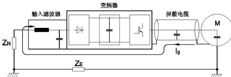
图 4-5 噪声滤波器的噪声电流示意图
