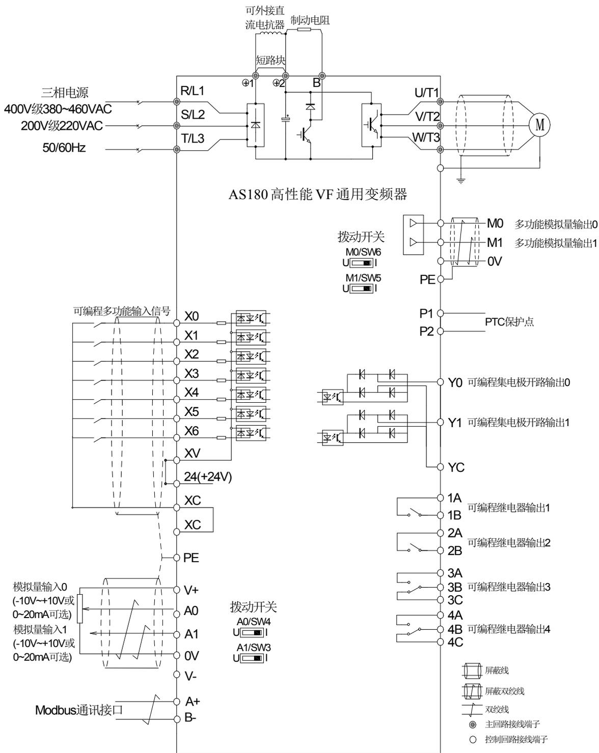
图 4-7 通用变频器端子配线示意图(30kW 及以下)
