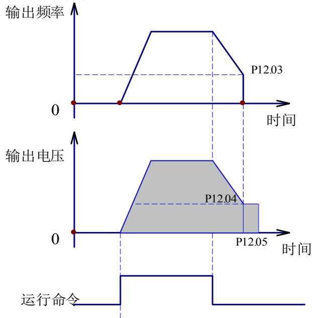
图 7-12 停车直流制动示意图
