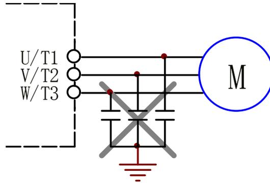
图 4-16 严禁在输出侧连接电容器的示意图
