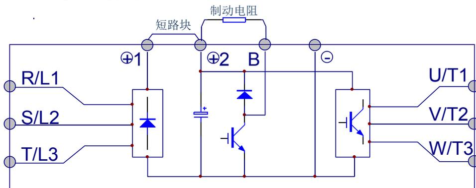
图 4-13 外接制动电阻的连接图
