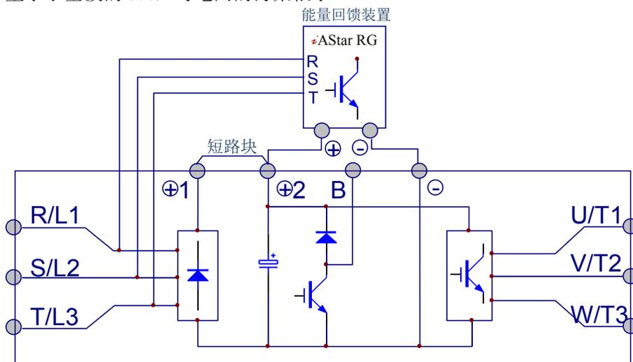
图 4-15 外接能量回馈装置图
