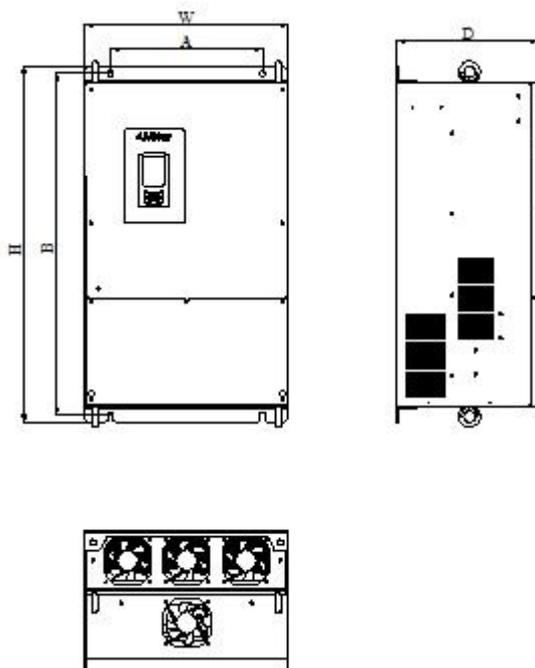
图 2-9 A4~A9 变频器安装尺寸
