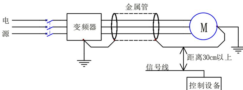
图 4-20 主回路配线的布置示意图 2
