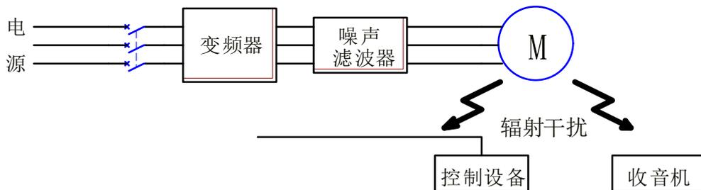
图 4-17 变频器输出侧噪声滤波器的接线
