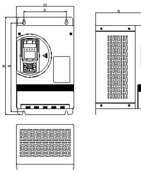
图 2-8 A2~A3 变频器安装尺寸
