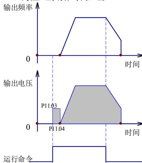
图 7-9 起动直流制动示意图
