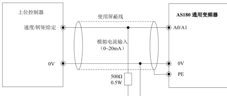
图 4-28 模拟量电流信号接线示意图
