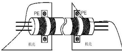
附图 A-4 正确的屏蔽接地方法
