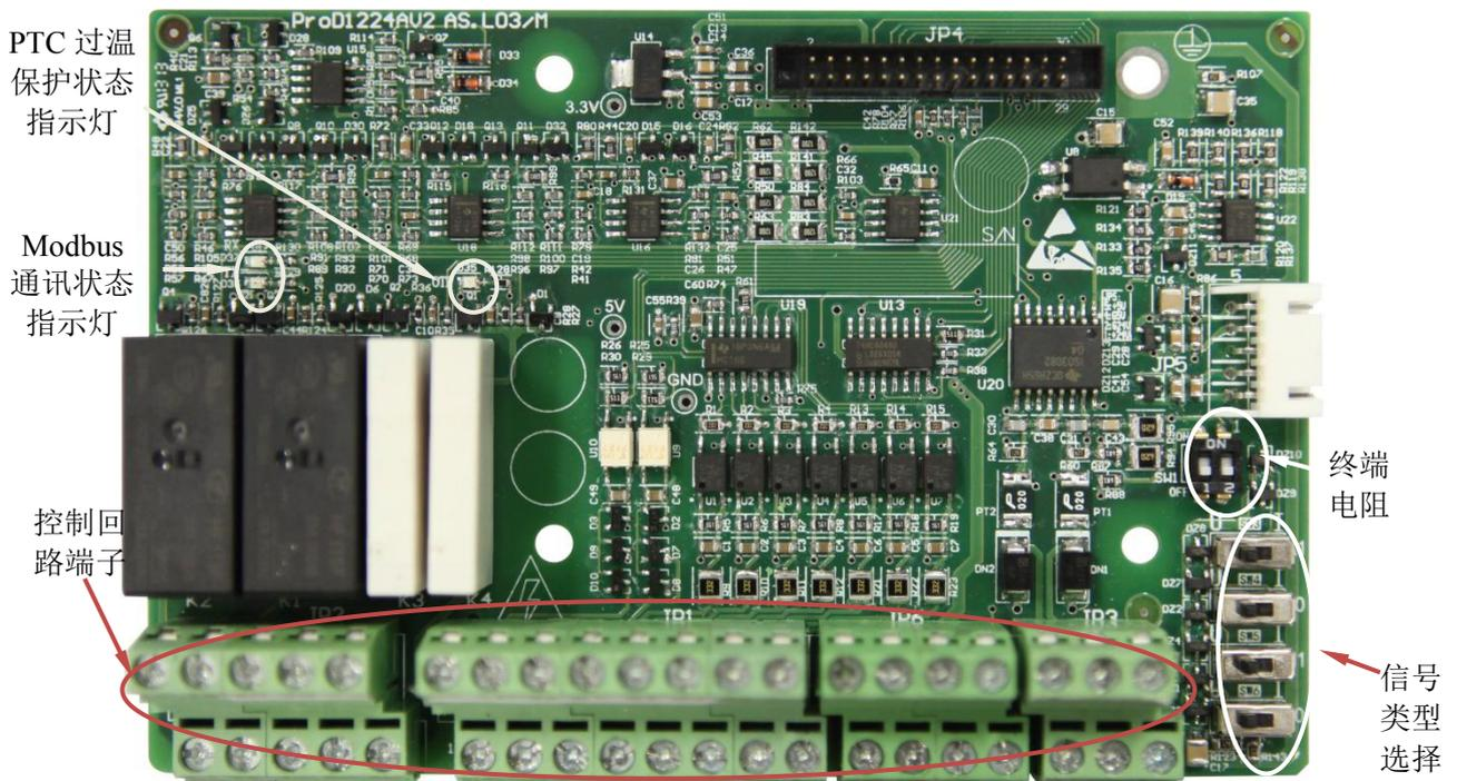
图 4-23 控制回路端子图片
