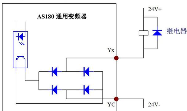
注：用此接线方式时若出现 Y0 或 Y1 端子损坏请务必确认外接二极管极性是否正确。
