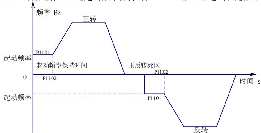
图 7-5 启动频率起动方式示意图
