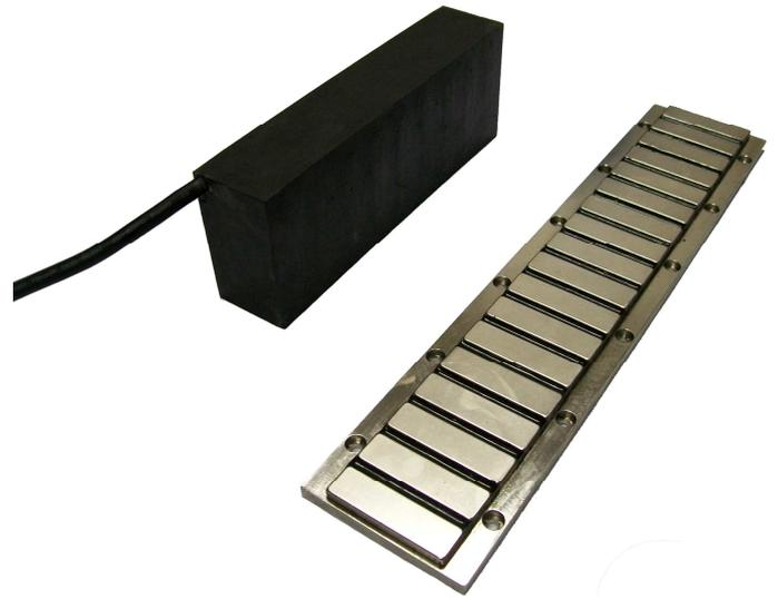
FS (Flat Servo) 系列大推力有铁芯直驱平板直线伺服电机采用全新的设计结构，配以高性能低损耗导磁材料作为精密绕组的导磁环路，专业的三维电磁场仿真优化将电机本身由齿槽效应和端部效应引起的推力波动降到最低。创新型的设计使该系列直线伺服电机能够产生比传统 **ILLSM** (Ironless Linear Servo Motor) 无铁芯直线电机更高的推力密度，实现小体积，大推力。无机械传动部件、直驱型设计、电机有更低的噪音、更小的磨损、更高的系统响应和系统精度。该系列电机主要有以下特点：
