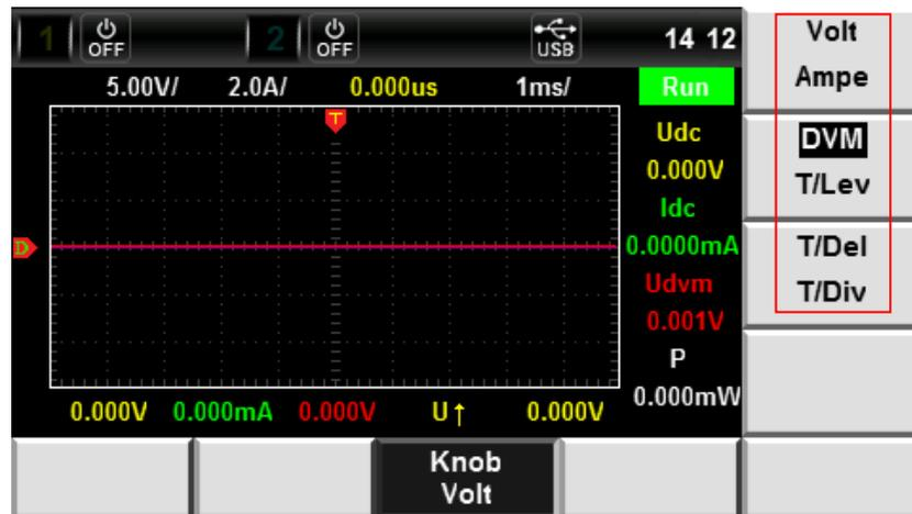
4. 在上图界面中，按下[Knob Volt]软键，此时显示“Knob DVM”，表明旋转旋钮可调整 DVM 通道接地电平。
