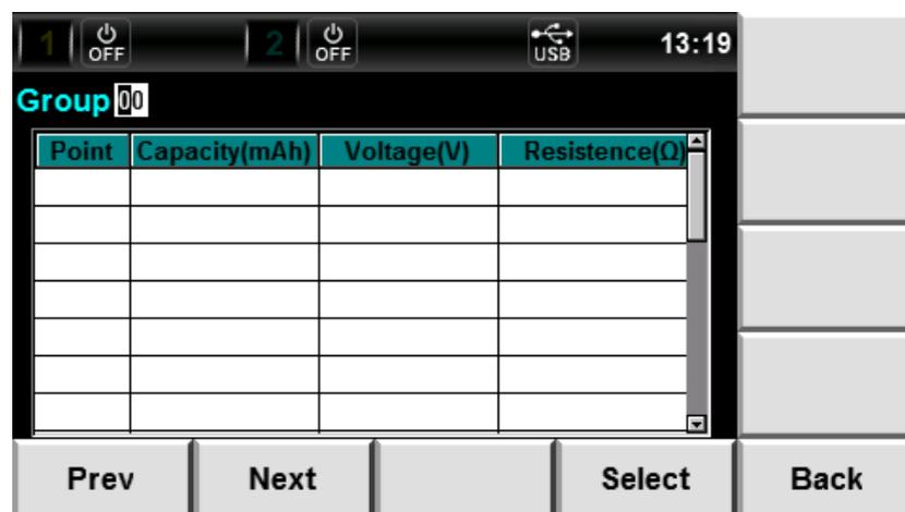
4. 设置 Group 编号。利用 ▲ ▼ 键，调节光标到 Group 设定处，按数字键或旋钮键设定需调用的数据组编号值。按[OK]键确认，此时特性数据显示区域显示该组各单步的特性数据。
