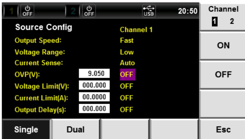
5. 按下右侧对应软键，设置 OVP 功能状态。ON: 打开 OVP 功能，OFF: 关闭 OVP 功能。
