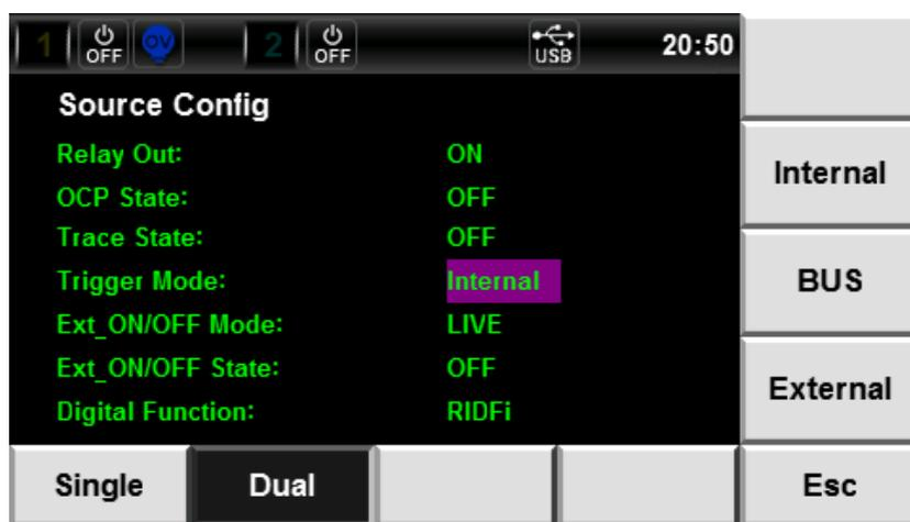
3. 按右侧参数对应的软键, 选择触发方式, 按[OK]键完成设置。
