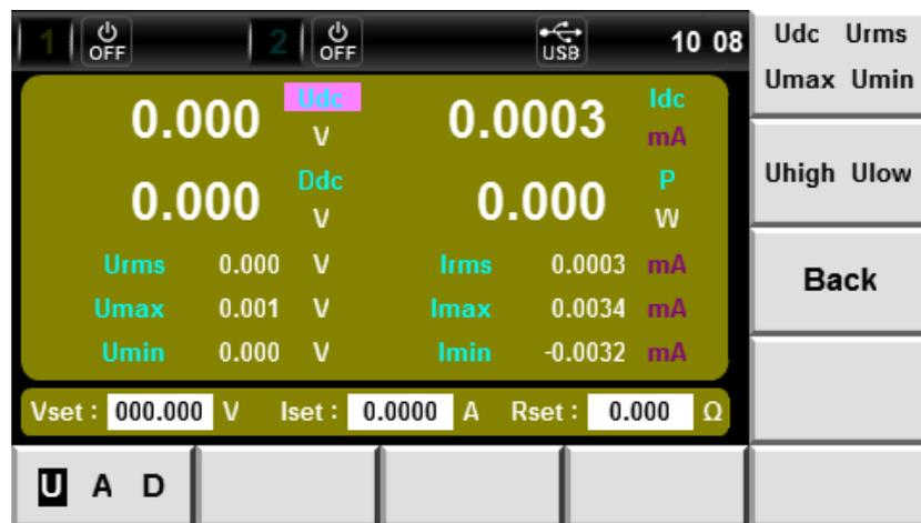
4. 按[U A D]软键，选择测量功能。例如每按一次[U A D]，显示的测量功能会按照 U/A/D 顺序切换一次。不同的功能显示不同的测量参数。
