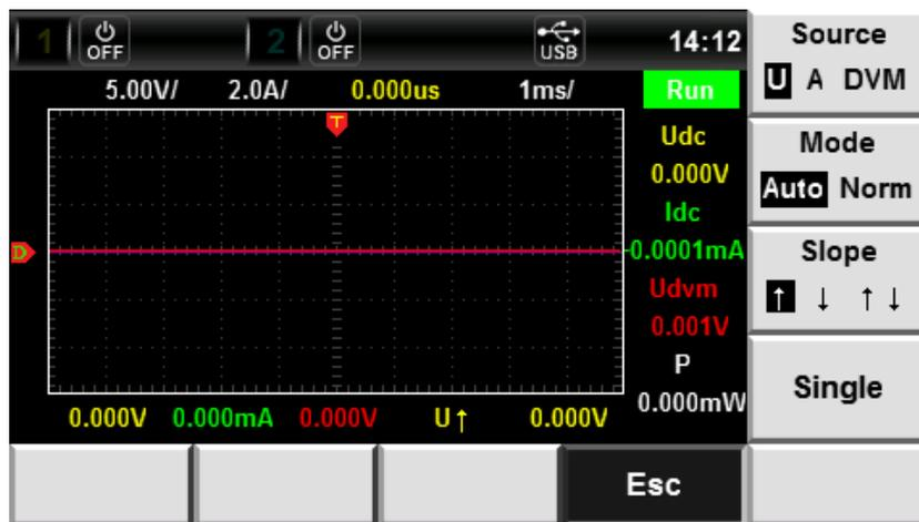
2. 按右侧参数对应的软键选择所需要的触发配置。
