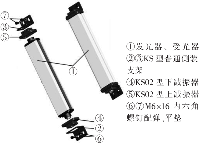
图 2.5 普通侧装方式(PC)
