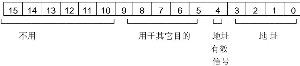
功能: 假设DO输出4位作为地址, 通过外部逻辑, 可以通过宏DI口得到与此地址相对的带有符号的3位BCD数值, 输出的地址及输入的数据信号仅在其有效信号=1时方有效, 输出时, 不用的位可送零, 用于其他目的的位不能改变其值, 以下例子为送地址7时, 读回相应的数据。
