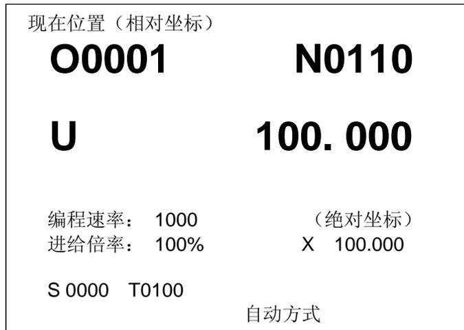
注1：S 显示主轴的实际转速时，必须在主轴上装有1024线的位置编码器。
