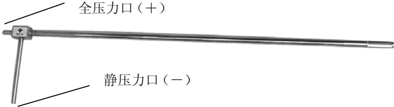
图 12: AF 空气流速探针
