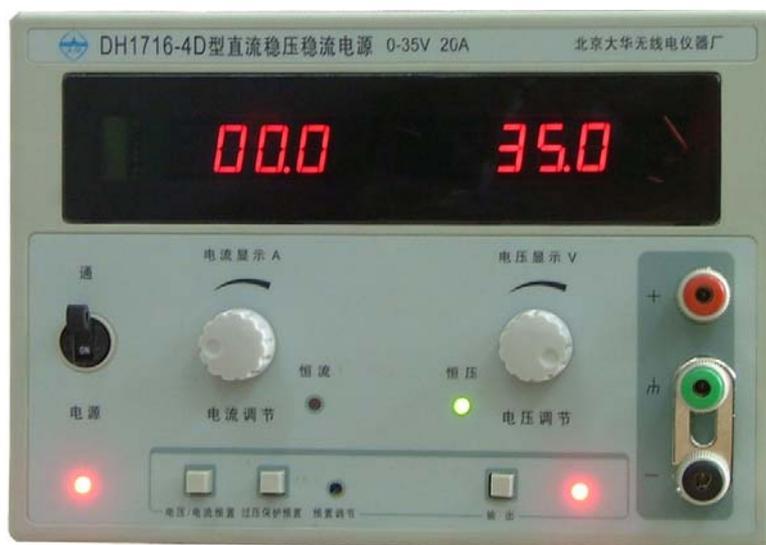
1. “电源”开关：交流输入电源通/断控制，“电源”开关置“通”时，下侧灯亮。
