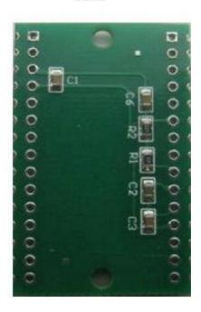
注意事项: 初次使用转接板,请先进行外观检查,察看有无虚焊,短路,断路等情况。
