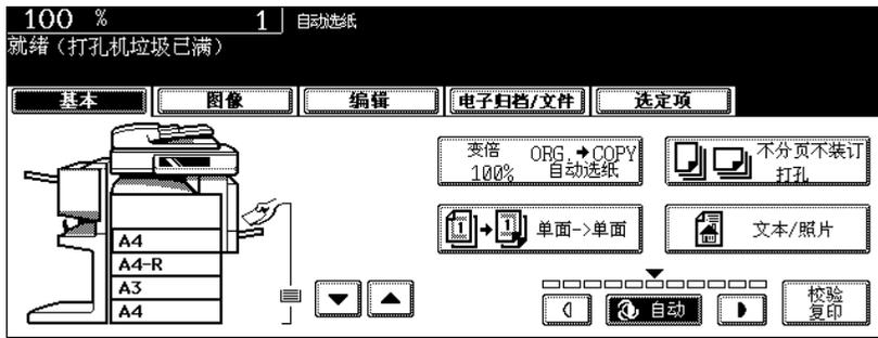
当打孔单元（选购件）中的打孔垃圾箱变满时，显示此信息。
