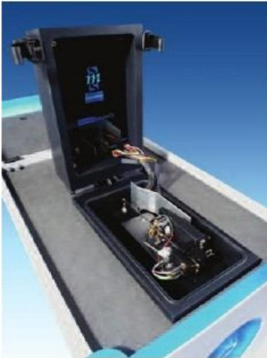
在DVS方法中，待测样品置于微量天平上，设定湿度的空气或氮气持续通过样品，样品周围形成相对湿度稳定的区域。水蒸气全面接触待测样品，水蒸气吸附/解吸平衡很快形成。由于水分吸附和解吸，样品重量引起变化，利用微量天平测量重量变化。配备超灵敏微量天平，1mg~100g质量范围的样品均可准确分析。许多利用传统方法需花费数月时间才能取得的吸附平衡数据利用DVS方法只需数个小时即可完成。
