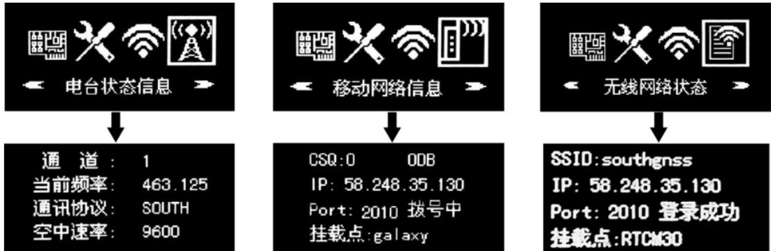
电台状态信息：基准站或移动站模式下，数据链为内置电台时，主机设置界面会出现电台状态信息显示界面。
