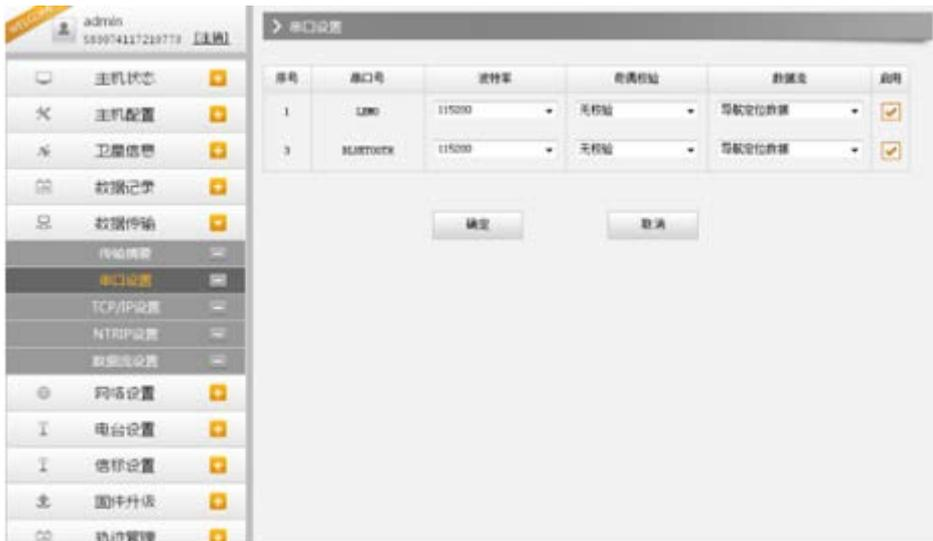
图 2.3-17 Web UI 数据传输-串口设置
