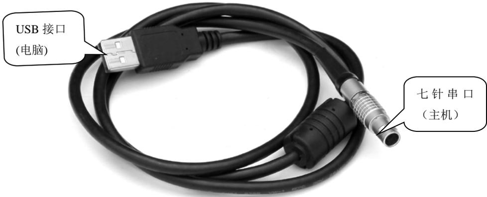
2) **七芯 OTG 线**: 七芯 OTG 线的作用是给 RTK 主机外接 U 盘使用, 可直接拷贝静态数据至 U 盘中。
