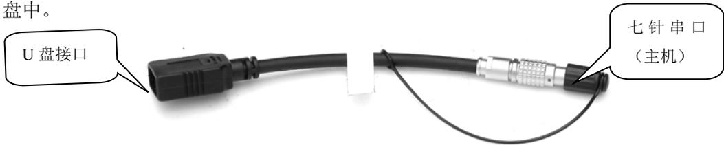
3) **差分口通讯电缆**: 差分口通讯电缆的作用是连接接收机主机和电脑, 输出主机串口数据。
