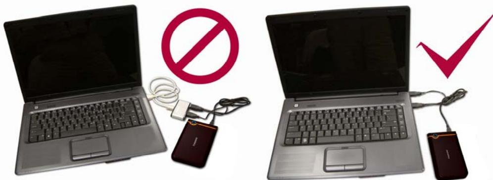
圖 17. 將 USB 傳輸線的二個接頭都插入電腦 USB 埠
