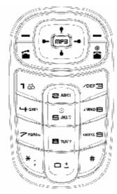
**左右键**:编辑时左右滚动光标;待机状态,按左键进入[系统设置]/[手机设置]/[指定功能键]/[左键]指定的功能,默认是情景模式,按右键进入[系统设置]/[手机设置]/[指定功能键]/[右键]指定的功能,默认是短信息;在照相机预览状态,按左右键调节曝光补偿值;在[我的文档]中,按右键相当于开启选定文件夹,按左键相当于返回上一级文件夹。
