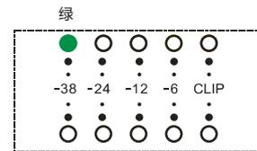
右侧 A 通道滤波器 LED 显示次版本号高位(例如“V1.0.2”中的“0”)，右侧 B 通道滤波器 LED 显示次版本号低位(例如“V1.0.2”中的“2”)
