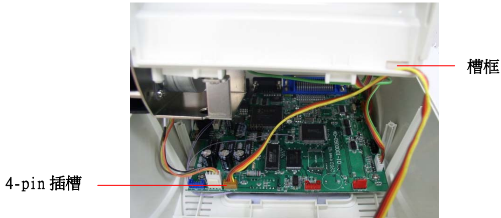
圖十四 安裝裁刀模組電纜線
