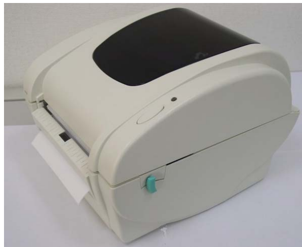
圖九 標籤安裝完成-剝紙模式
