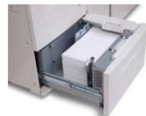
最突出的是，所有纸盘都能支持从60g/m<sup>2</sup>至300g/m<sup>2</sup>纸张。并可进行自动双面打印。如果增加一个第二组供纸模块(SFM)，就能进行长时间不间断生产——最大供纸量为8,000页。
