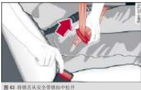
图 63 将锁舌从安全带锁扣中松开
