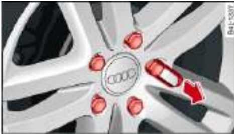
图 183 车轮：车轮螺栓及封盖
