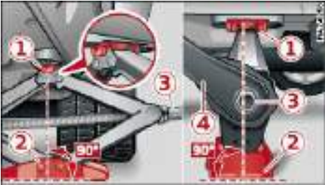
图 187 边梁：装上汽车千斤顶
