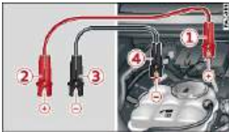
图 191 连接辅助启动电缆
