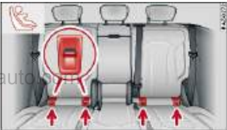
图 69 后座长椅：下面的 ISOFIX 固定座
