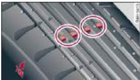
图 176 轮胎花纹：磨损指示
