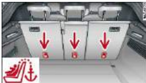
图 70 后座椅靠背：使用上部固定带的儿童安全约束系统 Top Tether 的固定卡座
