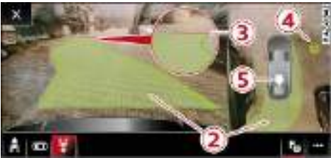
图 140 上面的显示屏：升级版驻车转向辅助系统的显示
