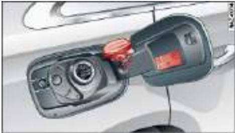
图 164 油箱盖板及插在其中的油箱封闭盖
