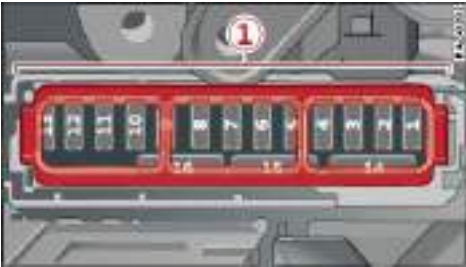
图 200 驾驶舱左侧：保险丝座及塑料夹子
