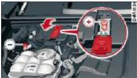
图 190 发动机舱：辅助启动电缆或充电装置的接口
