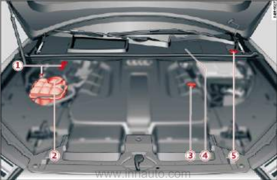
图 170 储液罐和发动机机油加注口的典型布置（实例）
