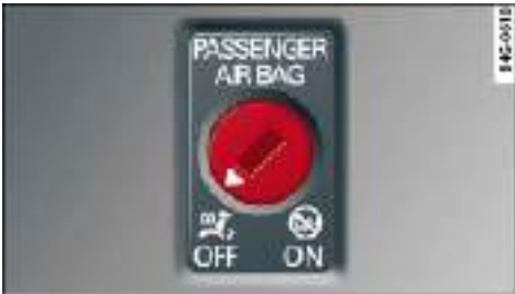
图 66 手套箱：用于关闭副驾驶安全气囊的钥匙开关
