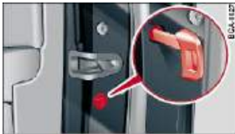
图 24 车门：给车门应急上锁
