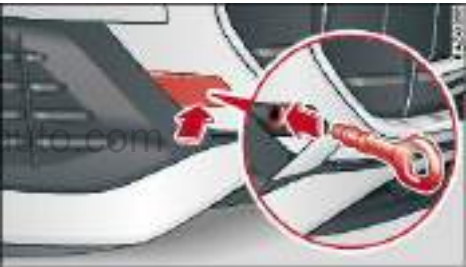
图 192 前保险杠：拧入拖车环（型号 1）
