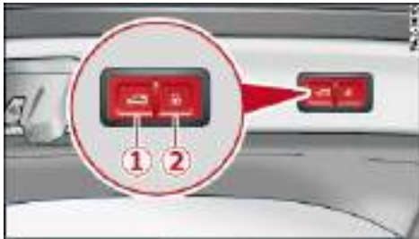
图 31 行李厢盖：① 锁闭按钮*、② 锁止按钮*（带便捷式智能钥匙*的汽车）
