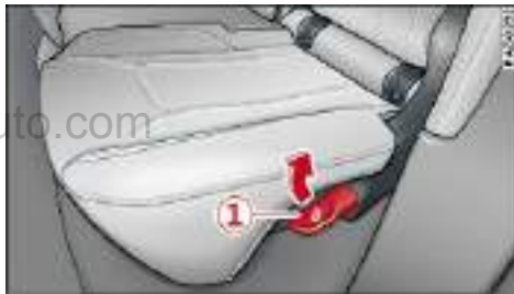
图 79 后座长椅：解锁杆
