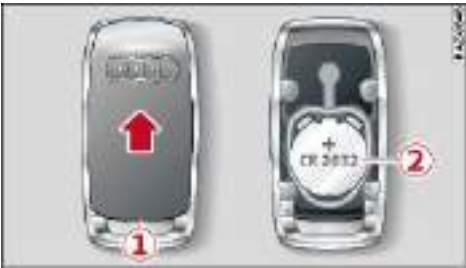
图 91 遥控器：更换电池
