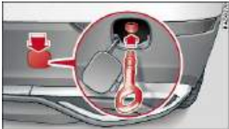
图 194 后保险杠：拧入拖车环（型号 1）
