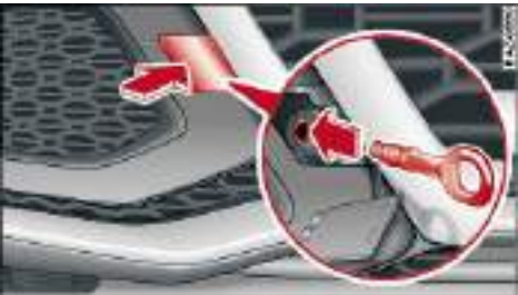
图 193 前保险杠：拧入拖车环（型号 2）
