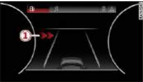
图 126 组合仪表：交叉路口辅助系统的方向显示
