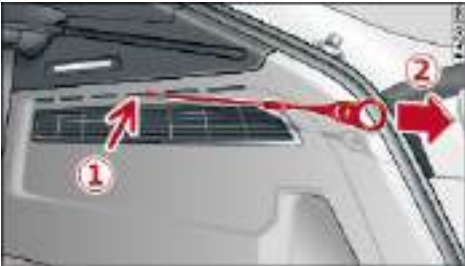
图 165 行李厢内右侧饰板：给油箱盖应急解锁
