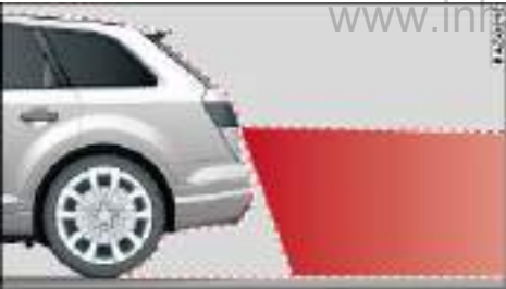
图 99 示意图：倒车摄像头的探测范围
