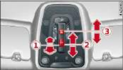
图 36 天花板：全景玻璃天窗和遮阳帘按钮*
